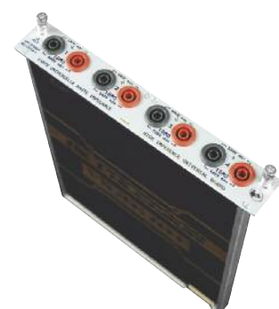
Carte Universelle Haute Impédance Identique à la carte universelle pour ses caractéristiques, elle dispose d'une impédance d'entrée de 10MΩ.
