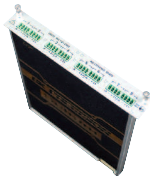
Carte Multiplexée Dédiée à l'enregistrement de signaux process, elle permet l'enregistrement de températures (Thermocouples, Pt100 - Pt1000,...) ainsi que de faibles tensions
