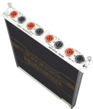
Carte Universelle Complètement isolée, polyvalente, elle permet l'enregistrement des signaux de quelques mV jusqu'à 600V.
