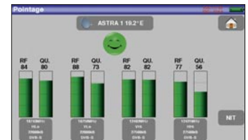
Pointeur satellite avec affichage de la NIT pour assurer un réglage optimal.
