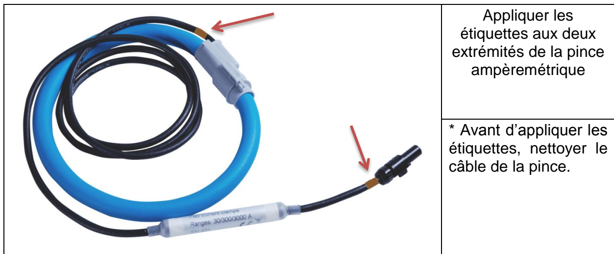
Image 3.2: Code couleur du capteur de courant
