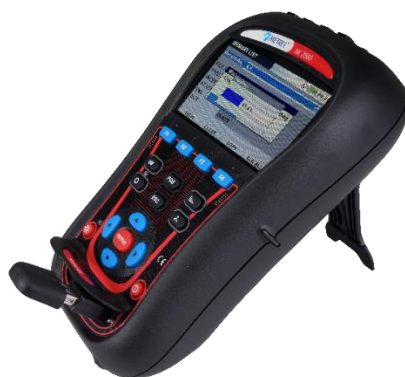
Image 6.1: Copie des données depuis l'appareil vers la clé USB.
