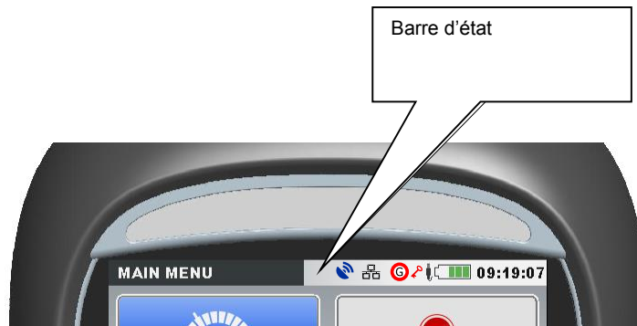
Image 2.3: barre d'état de l'appareil
