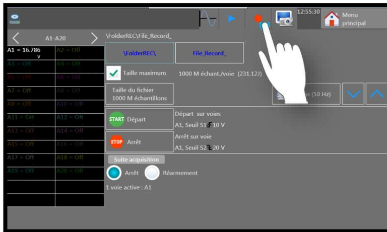
7- L'enregistrement est ainsi réalisé, seule la partie comprise entre 10 (front montant) et 20V (front descendant) a été enregistrée :
